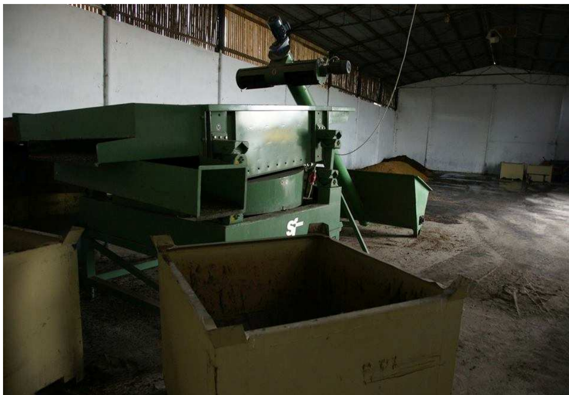
Obr. 11 Separační zařízení s rovinnými sítý s excentrickým pohonem
