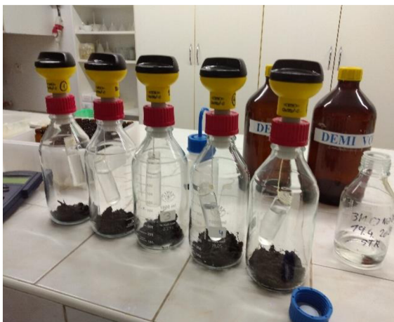
Obrázek č. 6: Měření respirace přístrojem OxiTop® OC 110, Foto: © Zuzana Blahová, 2021
