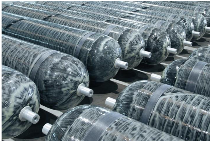
Obrázek 47 Kompozitní tlakové lahve firmy NPROXX [91]
