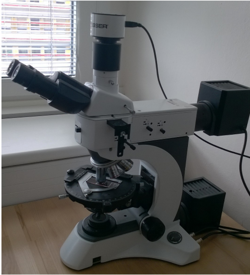
Obrázek 4.4: Polarizační mikroskop v laboratořích Ústavu Biomechaniky (Padim, Drex s.r.o., Česká Republika) s digitální kamerou (Bresser mikrokamera 5 megapixelů, Bresser GmbH, Německo)
