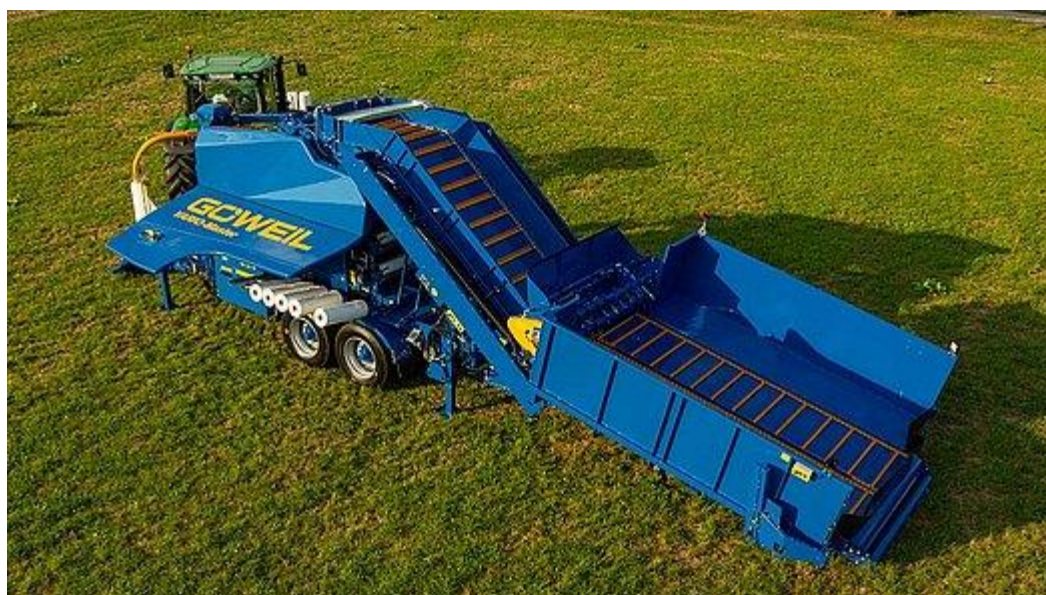
Obrázek č. 2: Kombinovaný lisovací a ovíjecí stroj VARIO-Master značky GÖWEIL (GÖWEIL 2023)
