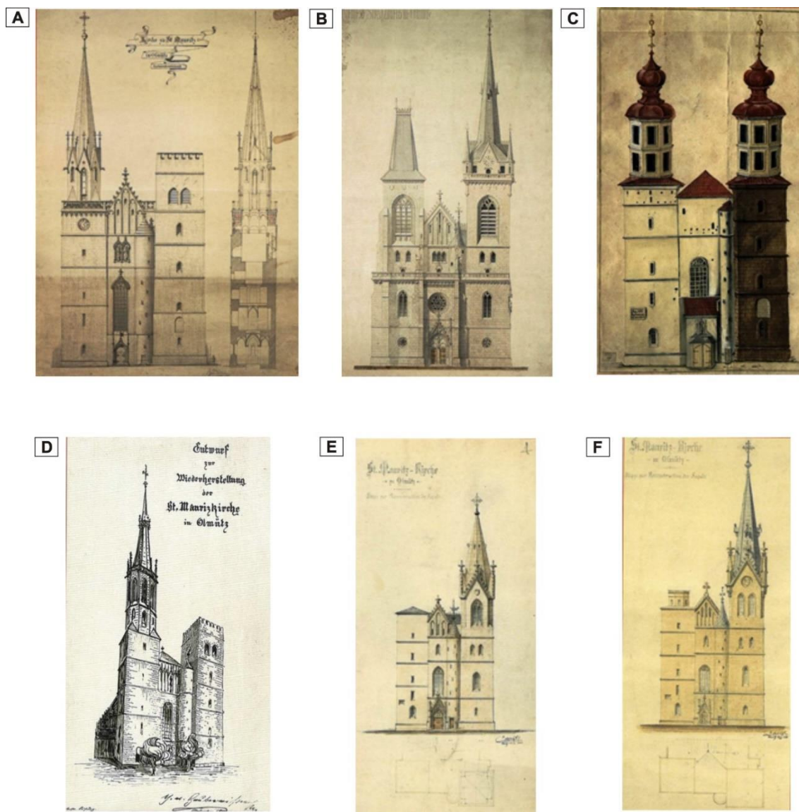
Obr. 12: Nerealizované plány rekonstrukcí kostela sv. Mořice v Olomouci. A – Plán rekonstrukce od architekta Richarda Volkera z r. 1891, B – Návrh rekonstrukcí věží a západního průčelí od Gustava Meretty, C – Anonymní nerealizovaný plán rekonstrukce průčelí, věže jsou v barokním stylu, D – Nerealizovaný plán rekonstrukce od George von Hauberrissera, E, F – Melnitzkého návrhy se liší jen v drobnostech, jako jsou výška jižní věže a počet oken jejího vrcholového segmentu, snížení severní věže a profilace dostavěného mezivěžového štítu (Kryl, Papoušek a Juráš 2020).
