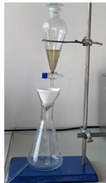
Obr. 2: Aparatura pro separaci těžké frakce. Vlastní fotografie.
