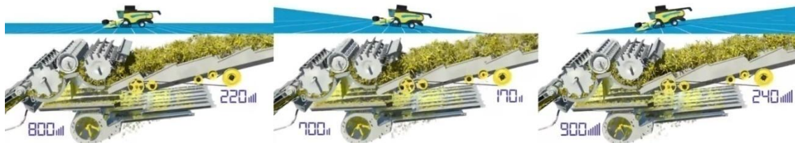
Obrázek 16 - Změna otáček vytřasadla [10]
