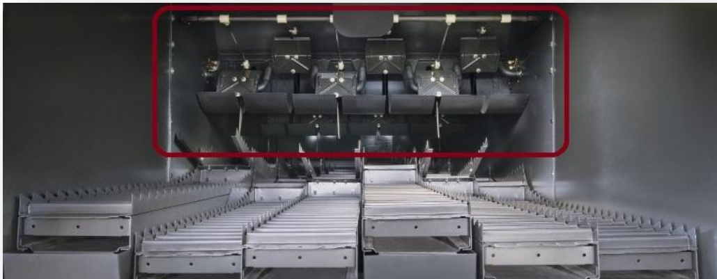
Obrázek 25 - Uložení kývavých čechračů nad vytřasadlem CLAAS TUCANO [9]
