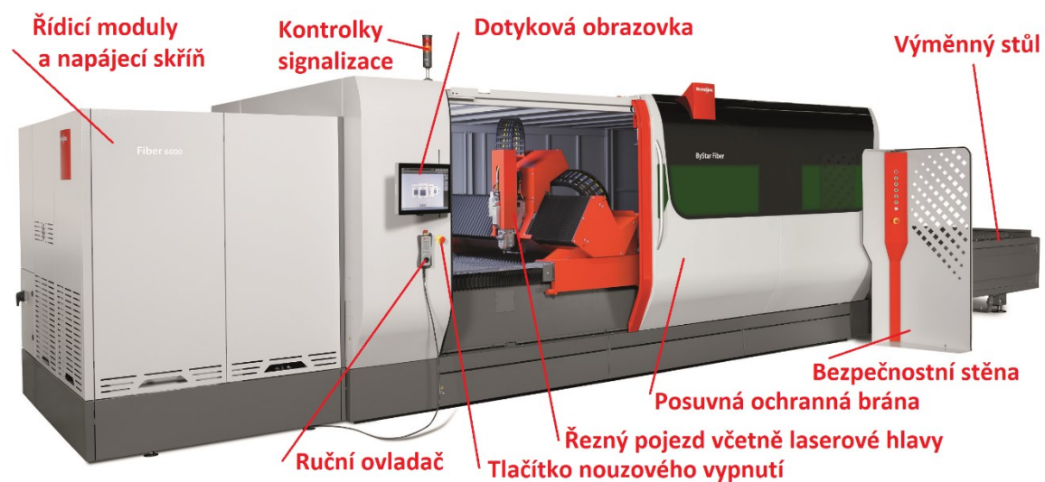
Obr. 7: Popis laserového obráběcího centra Bystronic ByStar Fiber 3015 [18]
