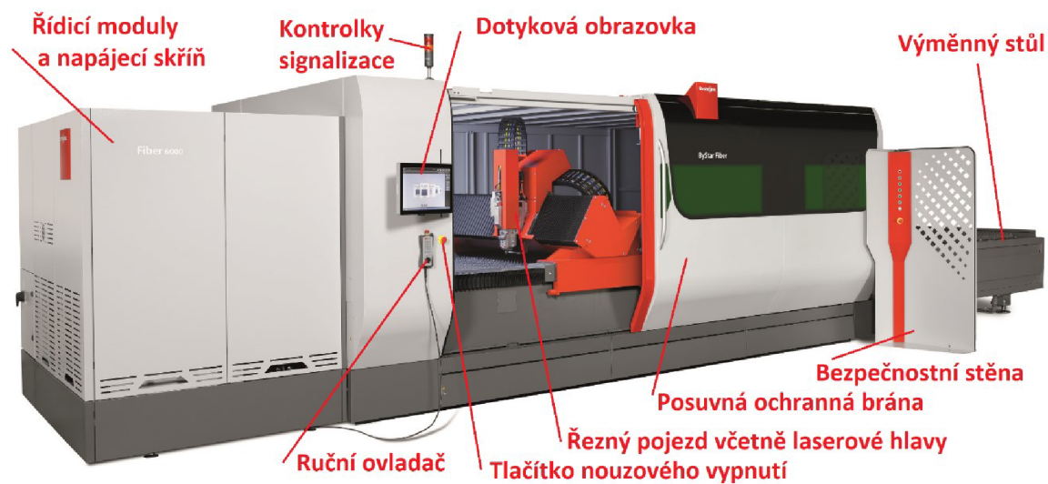
Obr. 7: Popis laserového obráběcího centra Bystronic ByStar Fiber 3015 [18]
