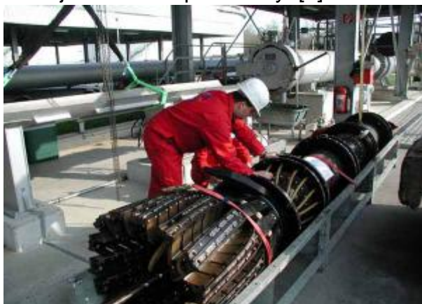
Obr. 1.6 a 1.7 Příprava inspekčního ježka k běhu potrubím [1]
