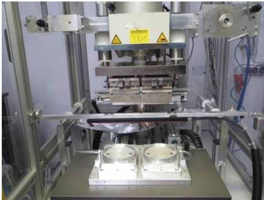
Obrázek 14: Zařízení Geba 32/SV pro technologii Hot stamping (Zdroj [23])
