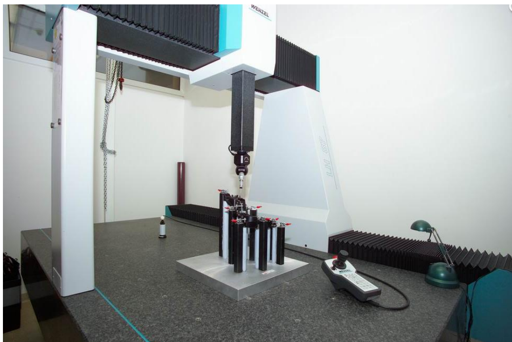
Obrázek 15: Stroj Wenzel LH 87 pro 3D měření (Zdroj [23])
