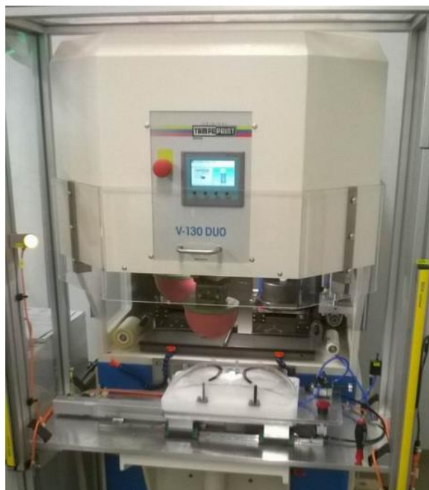
Obrázek 13: Stroj V-130 Duo pro tampónový tisk (Zdroj [23])
