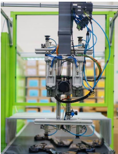
Obrázek 11: Robot a stroj Engle pro výrobu vylisků (Zdroj: vlastní zpracování dle [23])
