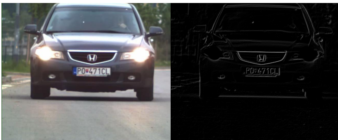
Obrázok 3.3: Ukážka aplikácie hranového operátora (Sobel)
