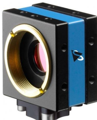
Obrázok 2.2: Kamera Imagingsource DFK22BUC03[14]
