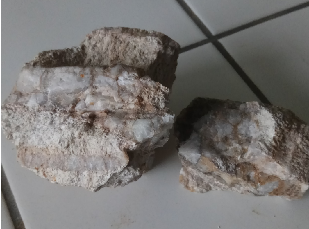
Obr. 14: Vzorek cenomanského pískovce kolektoru A z vrtu BJ-23.
