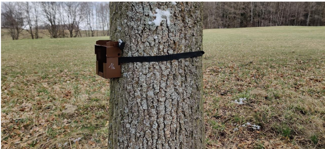
Obr. 20: Připevnění zamykacího boxu na strom
