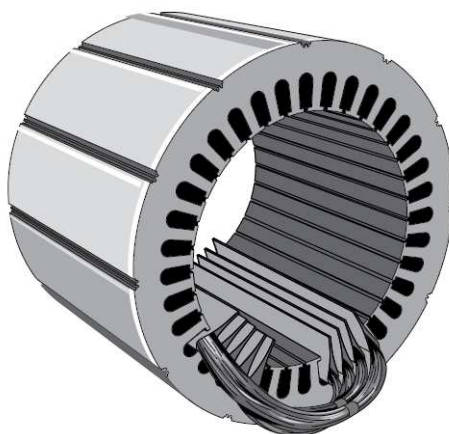
Obrázek 1 Svazek statorových plechů s ukázkou uložení vinutí [18]
