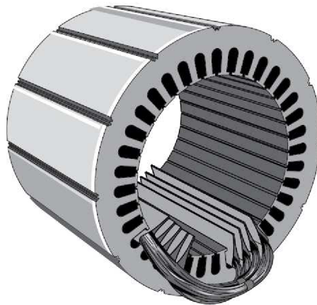
Obrázek 1 Svazek statorových plechů s ukázkou uložení vinutí [18]
