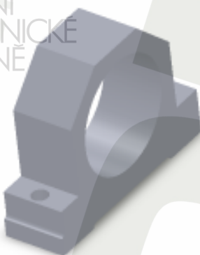
Obr. 70 3D model ložiskového domku pro uložení kuličkového šroubu v korní části
