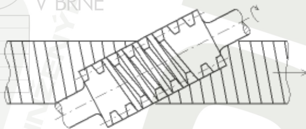
Obr. 11. Mechanismus šneku a hřebene
