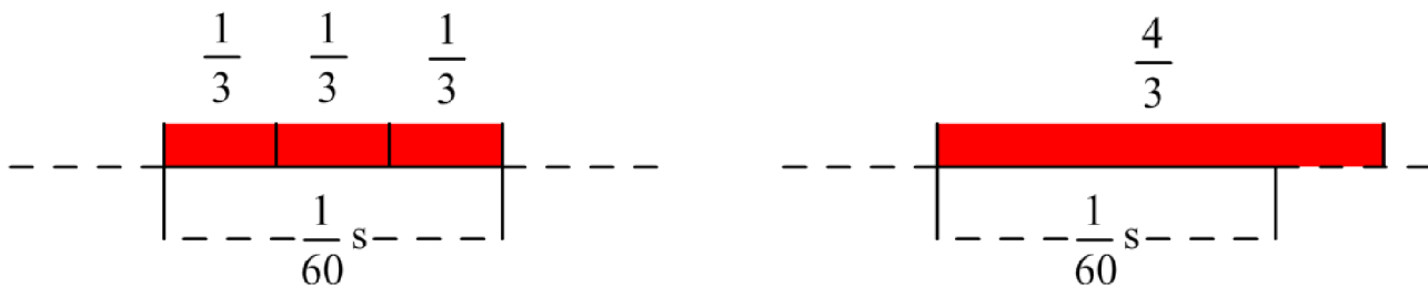
Obrázek 2.1.3: V tomto konceptu se nečeká na frekvenci ale snímky jsou zpracovávány neustále, přičemž se počítá jejich poměr času zpracování vůči referenčnímu času.
