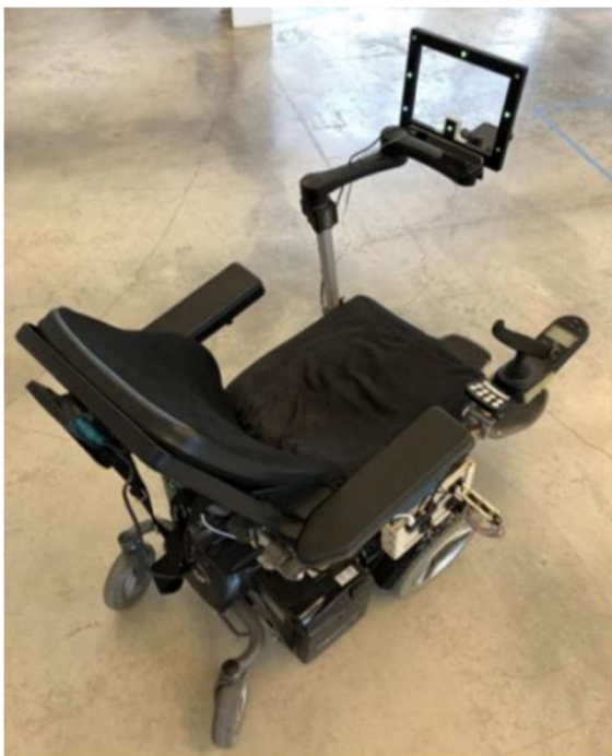
Obrázek 13 - Invalidní vozík s prototypem See-Thru (převzato ze Singer & Hartmann, 2019, p. 465)
