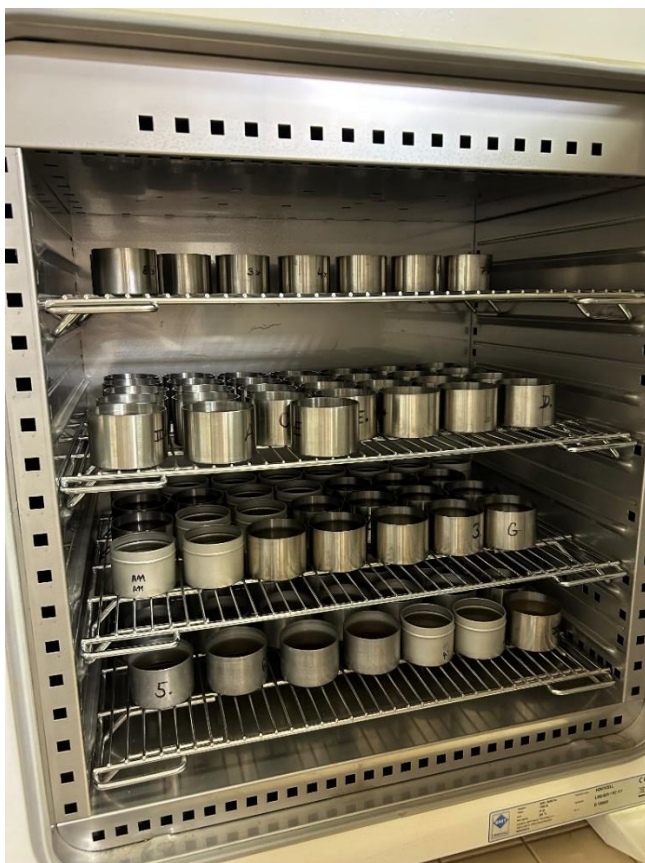
Sušení vzorků v přístroji Venticell (foto: autor, 2024)
