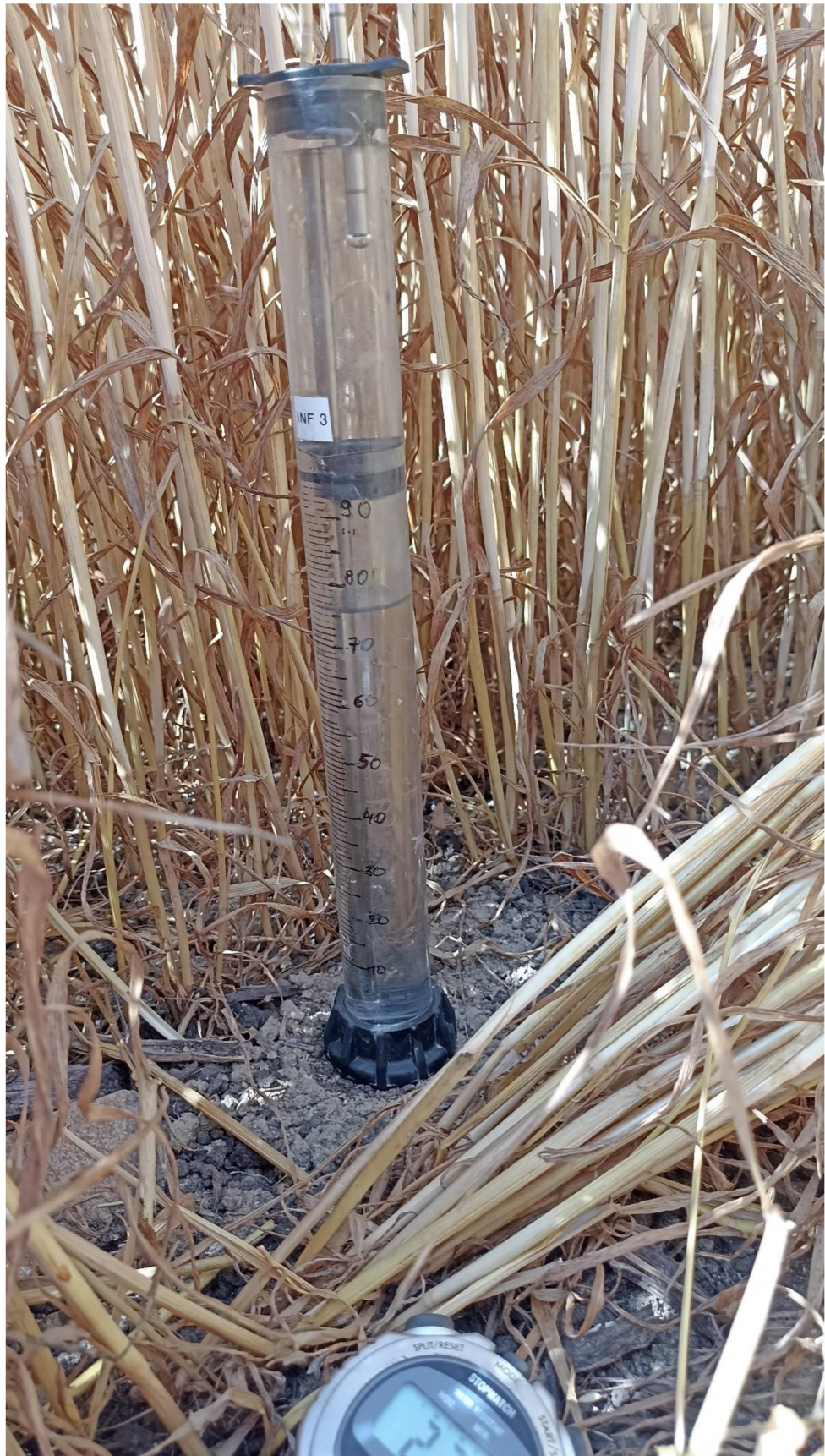
Měření nenasycené hydraulické vodivosti v lokalitě A: Blatnice u Jaroměřic (foto: Miháliková, 2023)
