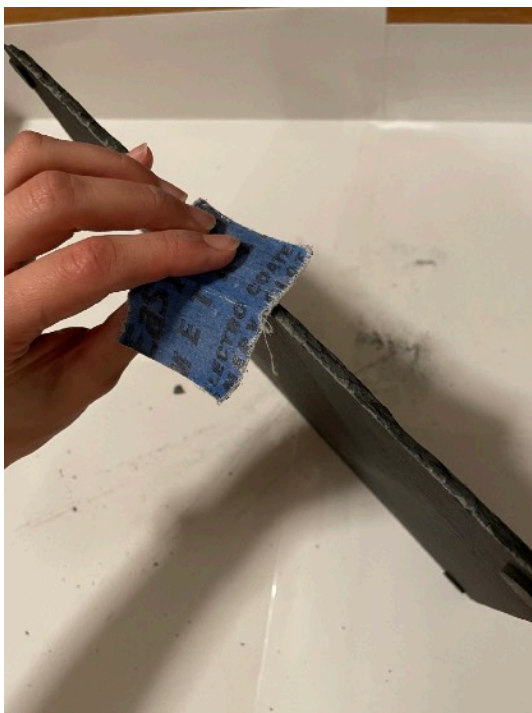
Obr. 52: Průběh práce na finálním díle (broušení hran)
