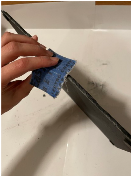
Obr. 52: Průběh práce na finálním díle (broušení hran)
