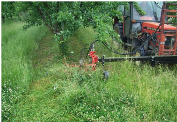
Obr. č. 1 : Mechanická kultivace plevelů v příkmeném páse
