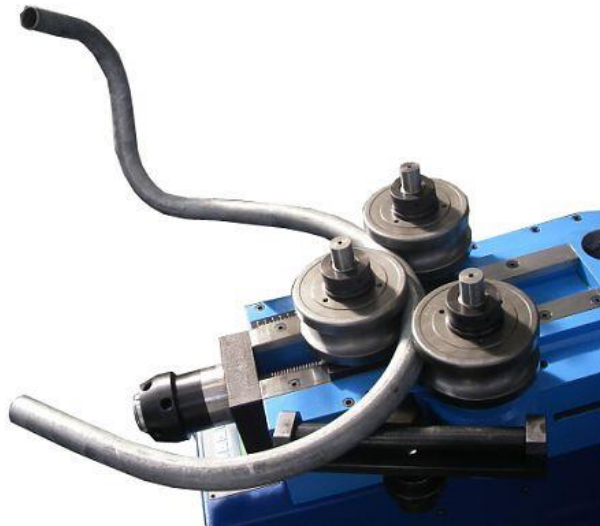
Obr. č. 8: Zakružování trubek
