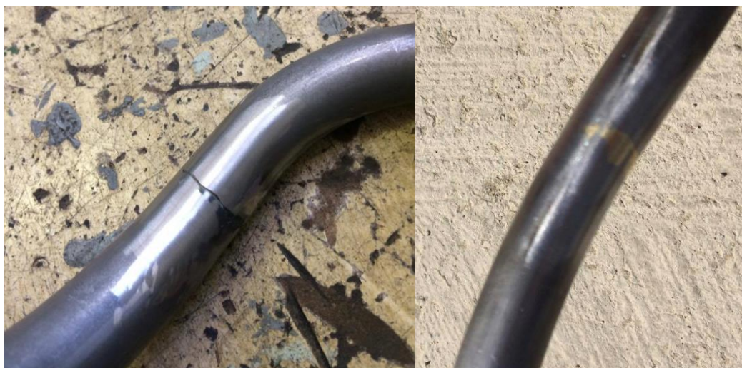
Obr. č. 71: Probroušený povrch trubky a povrch po zacelení mosazí
