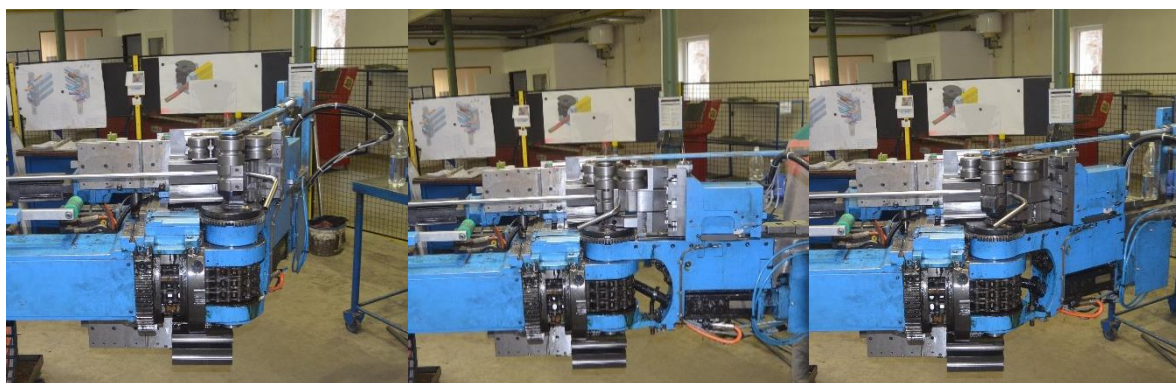
Obr. č. 64: Průběh ohybu trubky
