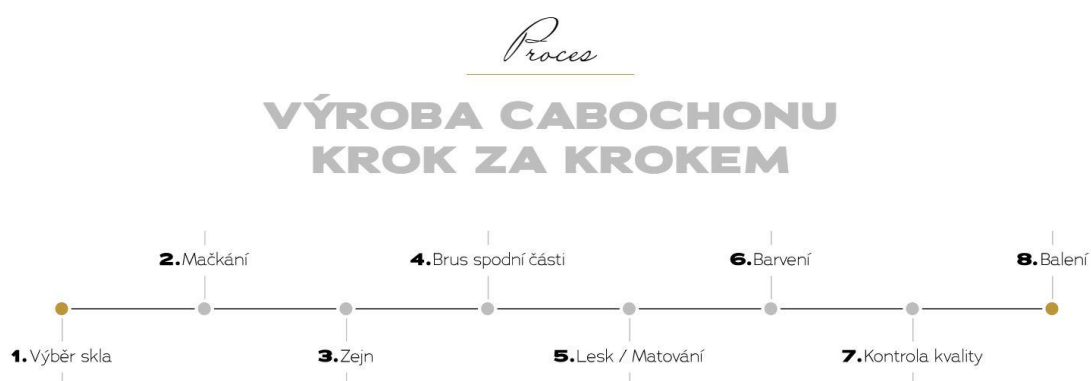
Obrázek 122: Popis výrobního procesu Cabochonu round Zdroj: pulirna.com 2022
