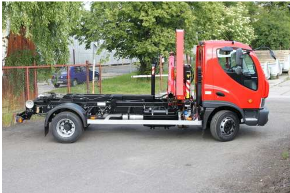
[obr. 28] Avia D120 L s jednoramenným nosičem kontejnerů CTS 5t a hydraulickým jeřábem FASSI F65A.22
