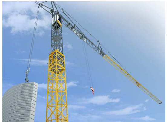
[obr. 22] Věžový jeřáb LIEBHERR 65 K
