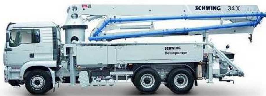
[obr. 26] Čerpadlo na beton SWING S34X
