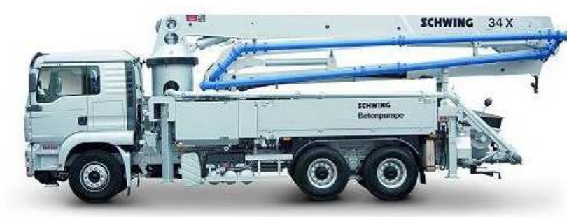
[obr. 26] Čerpadlo na beton SWING S34X
