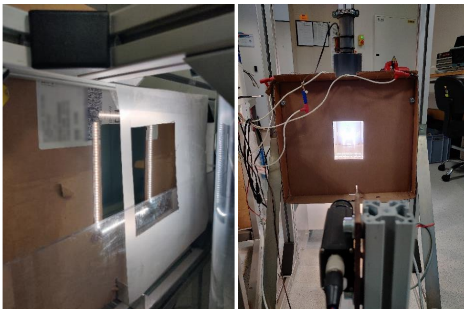
Obrázek 5.14 Přepážka s LED pásy (vlevo) a pohled od kamery (vpravo)
