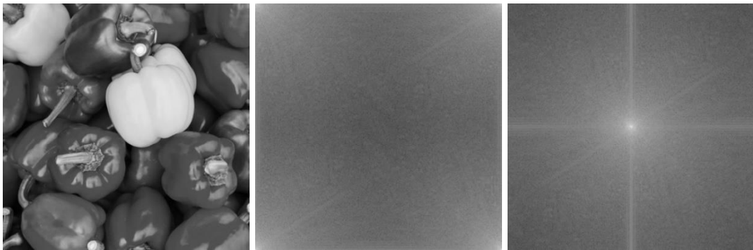
Obrázek 2.9 Papriky [22] (vlevo), jejich frekvenční spektrum před (uprostřed) a po provedení FFT shift (vpravo)
