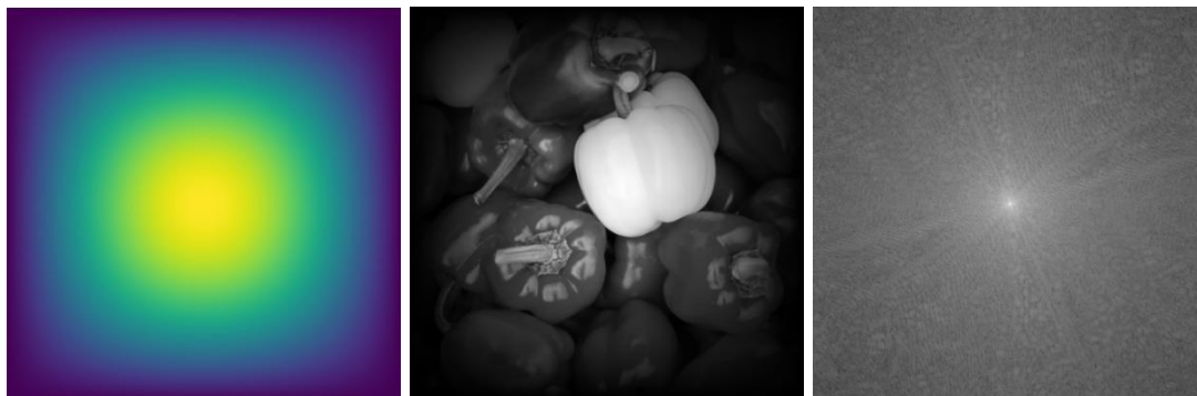
Obrázek 2.10 Hanningovo okno (vlevo), snímek paprik po jeho aplikaci (uprostřed) a vypočtené frekvenční spektrum (vpravo)
