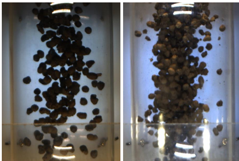
Obrázek 6.1 Padající keramzit – před (vlevo) a po (vpravo) úpravě osvětlení
