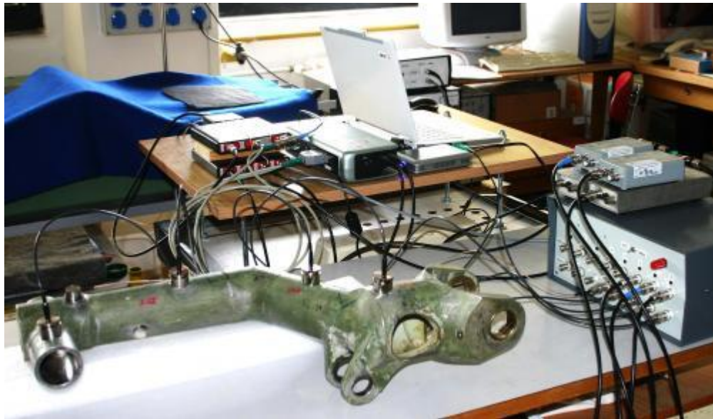
Obr. 7.3 Nelineární ultrazvuková spektroskopie části leteckého podvozku [19]
