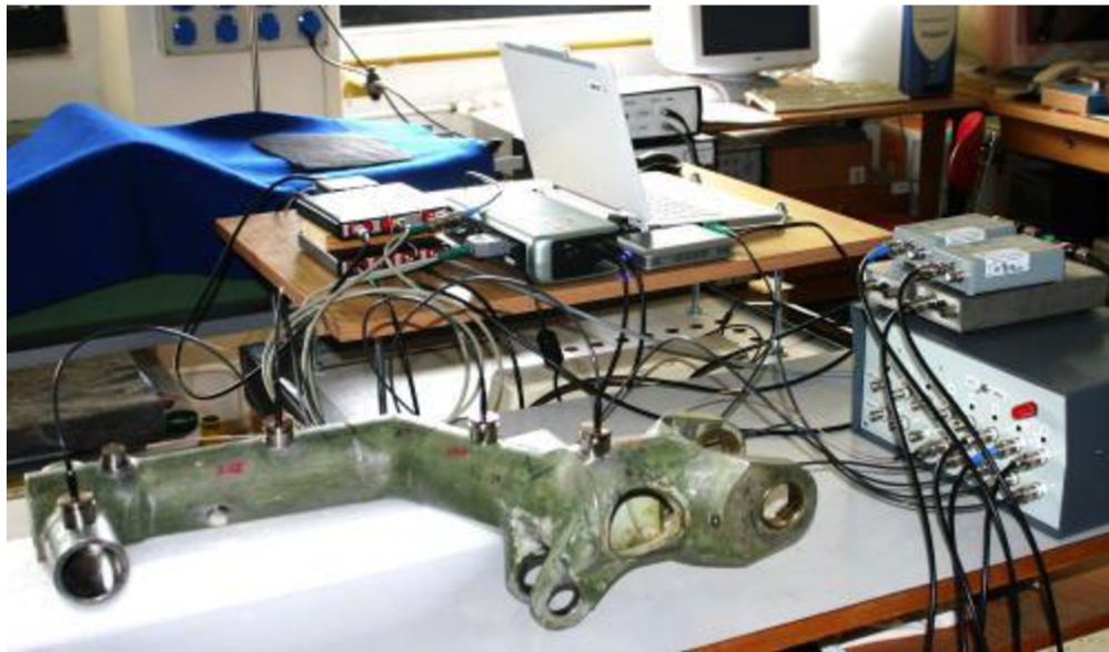
Obr. 7.3 Nelineární ultrazvuková spektroskopie části leteckého podvozku [19]
