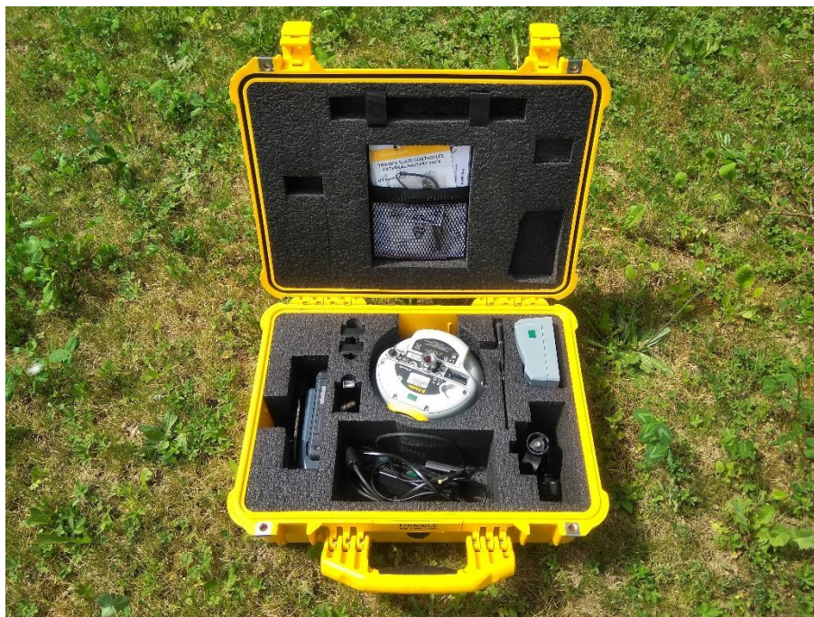
Obr. 7: GNSS aparatura Trimble R4
