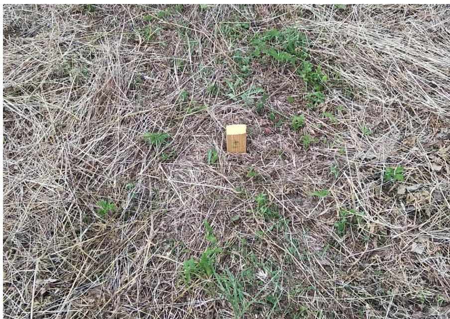
Obr. 9: Dočasná stabilizace bodu
