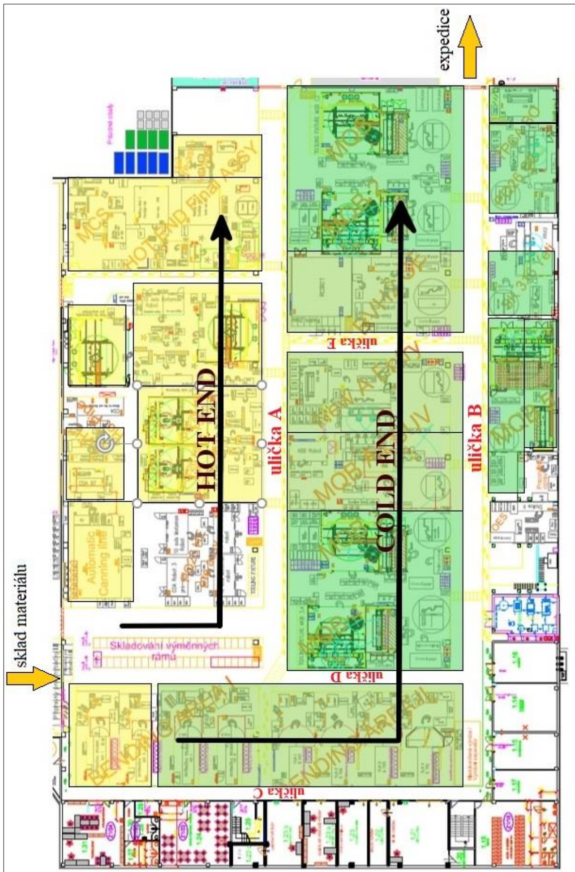
Obr. 3: Tok materiálu, rozložení výrobních linek Zdroj: vlastní zpracování podle Monroe (2018c)
