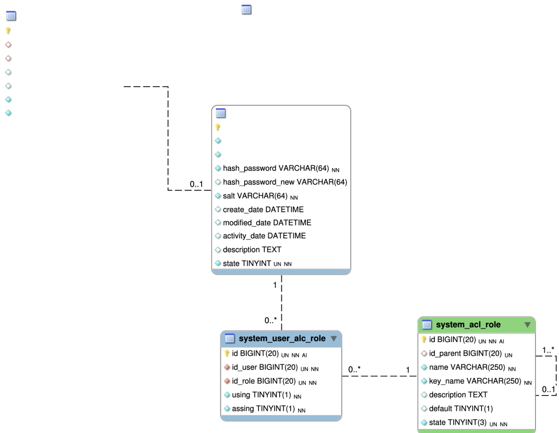
Obr. B.7: ER diagram – Uživatel, přidělení rolí a uživatelské nastavení.
