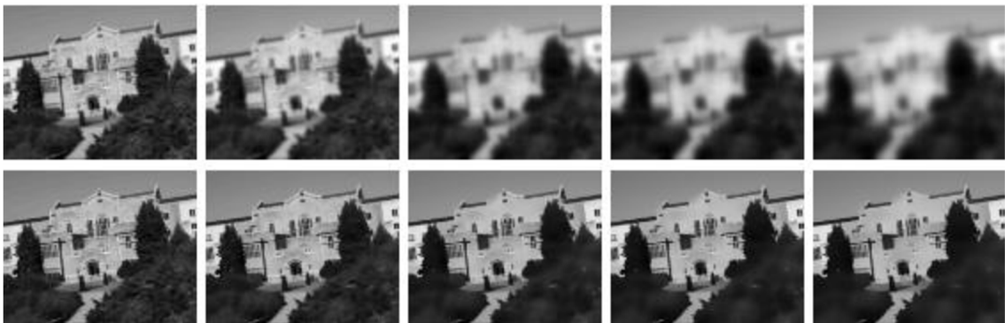
Obrázok 3.3-10 - Porovnanie použitia Gaussového filtra (hore) a nelineárneho difúzneho filtrovania (dole) [69]
