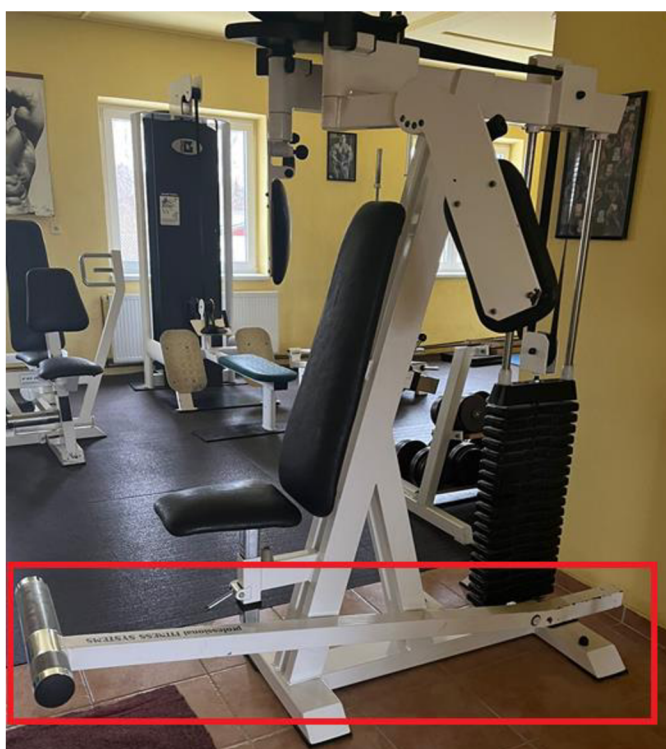
Obrázek č. 14: Peck Deck (červený rámeček vyznačuje bezpečnostní páku stroje)
