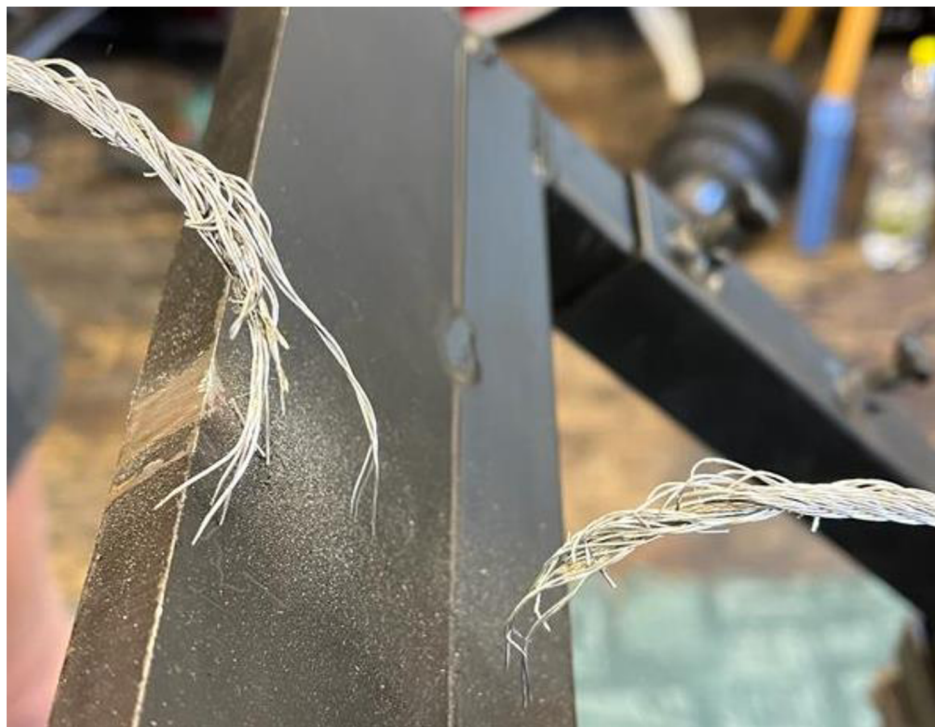
Obrázek č. 38: Přetržení ocelového lana po provedení 4860 cyklů.
