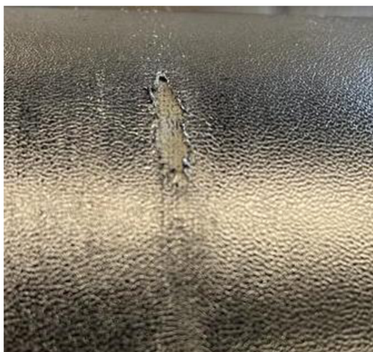
Obrázek č. 43: Poškození povrchu koženky po provedení 1600 cyklů.
