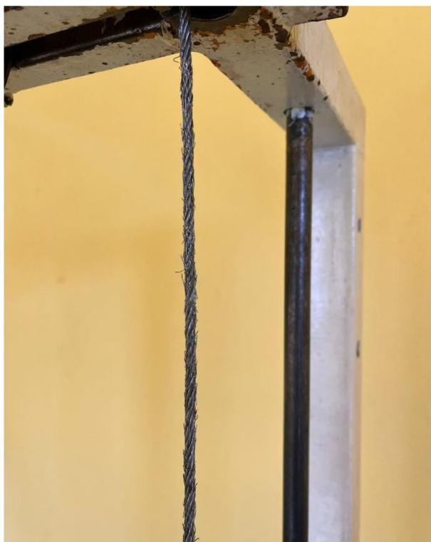
Obrázek č. 25: Otřepy vzniklé u ocelového lana.
