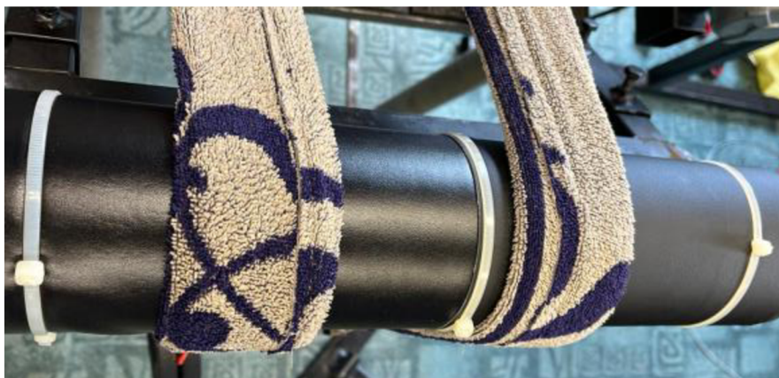
Obrázek č. 45: Způsob uchycení pracovních pásek na testované materiály sedacích částí.
