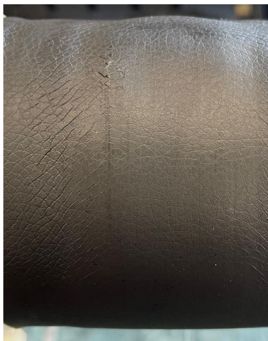
Obrázek č. 48: Otláčení eko kůže po provedení 10000 cyklů.
