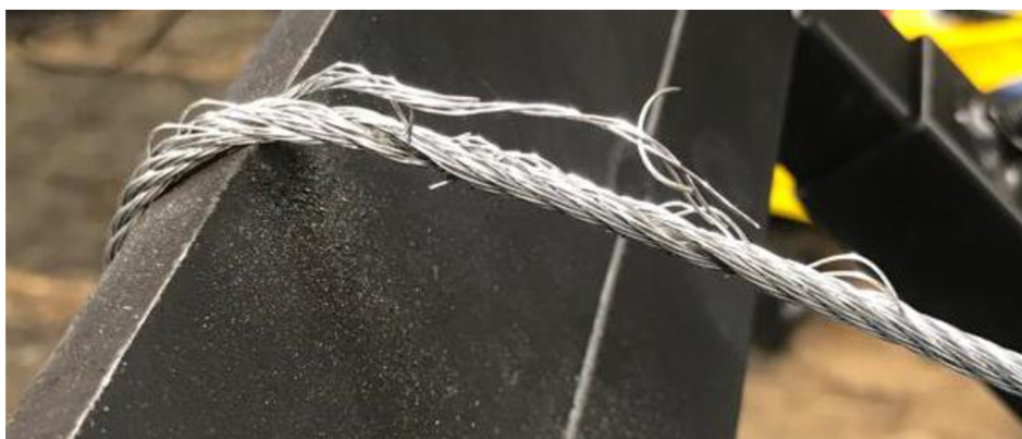
Obrázek č. 36: Ocelové lano po provedení 3920 cyklů.
