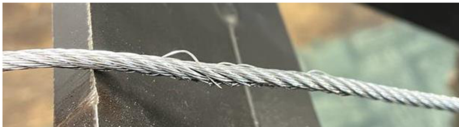
Obrázek č. 35: Kontrola ocelového lana po provedení 2320 cyklů.
