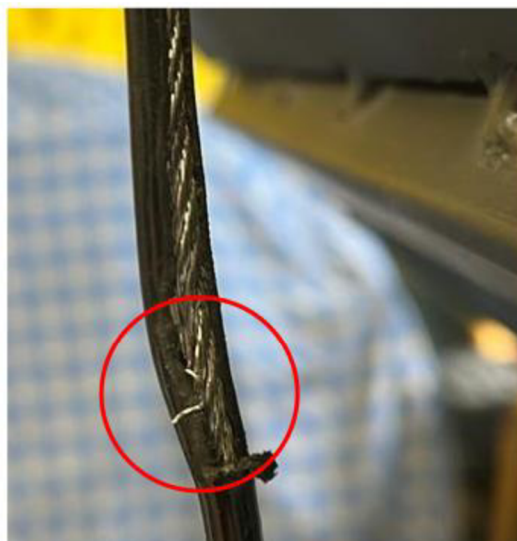
Obrázek č. 39: Poplastované lano při dosažení 6500 cyklů (poškození je viditelné v červeném rámečku).
