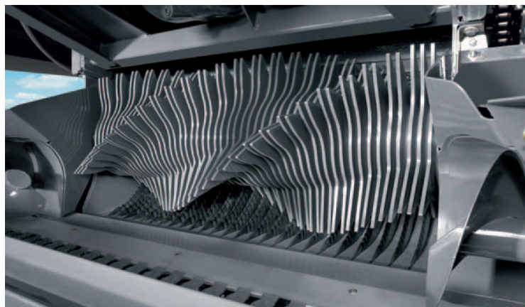
Obrázek 7: Řezací ústrojí lisu Claas Rollant 454, 454 Uniwrap [16]
