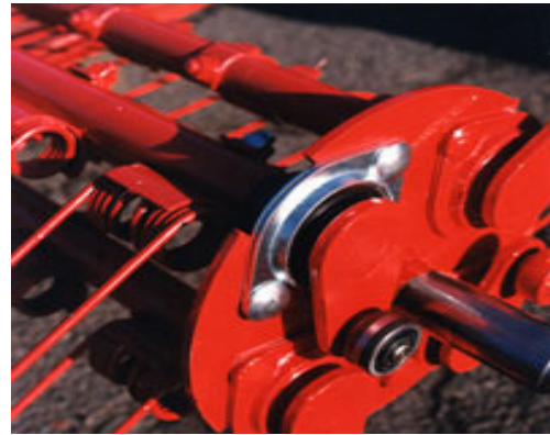
Obrázek 2: Sběrací ústrojí Lely Welger RP 235 uložení nosníku prstů v kuličkových ložiscích [14]
