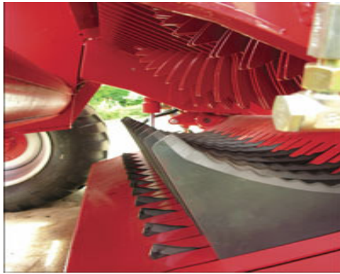
Obrázek 5: Řezací ústrojí Lely Welger RP 235 [14]
