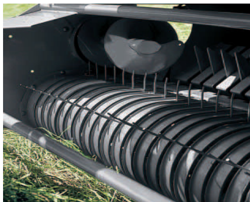
Obrázek 3: Sběrací ústrojí u lisu Claas Rollant 350, 340 [17]
