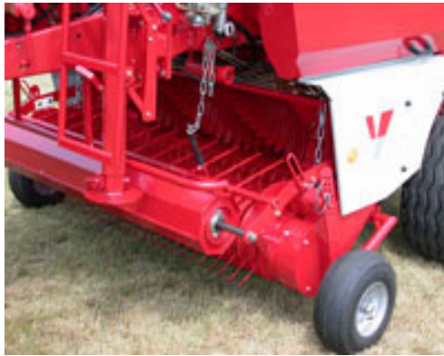
Obrázek 1: Sběrací ústrojí u lisu Lely Welger RP 235 [14]
