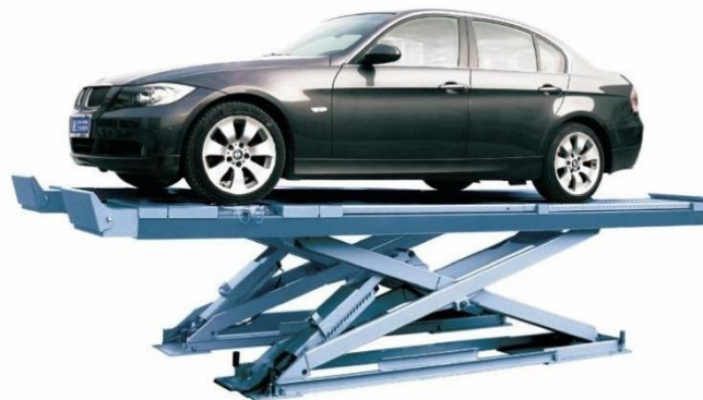
Obr. 7 Nůžkový zvedák pro zvedání za kola [7]
