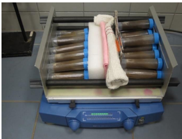
Obr. 8 Třepání vzorků na třepačce IKA H3 260 basic. Foto: M. Němcová.
