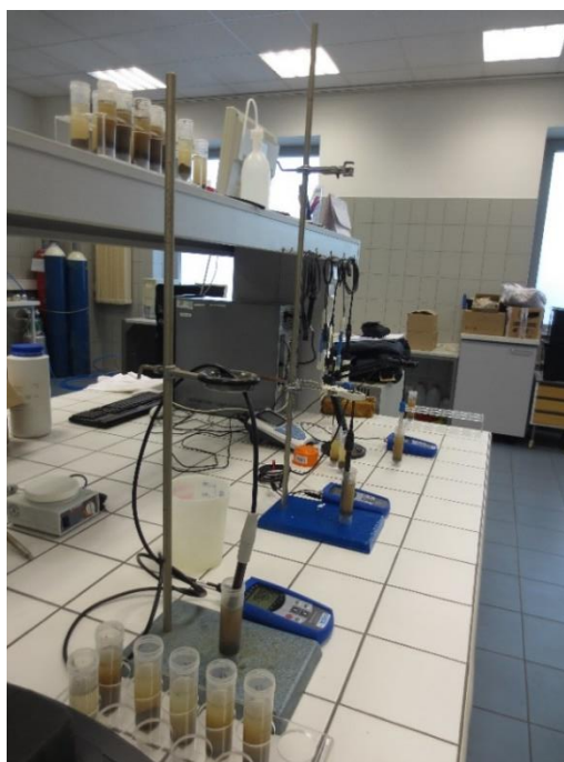
Obr. 9 Měření pH, ORP a konduktivity v laboratořích Ústavu zemědělské, potravinářské a environmentální techniky. Foto: M. Němcová.
