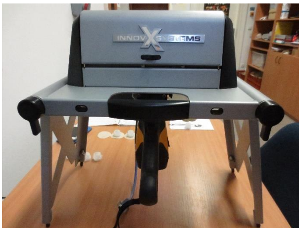
Obr. 10 RFA analýza na přístroji BAS DELTA. Foto: M. Němcová.
