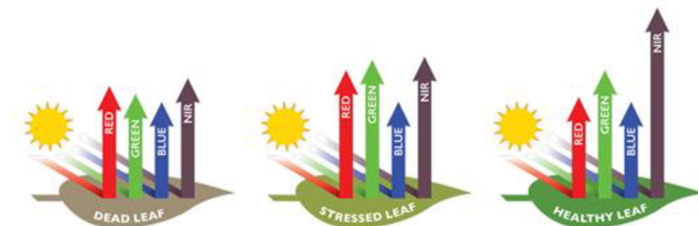
Obrázek 3: Změna odrazivosti v jednotlivých pásmech při stresu nebo odumření vegetace (Antognelli 2018).
