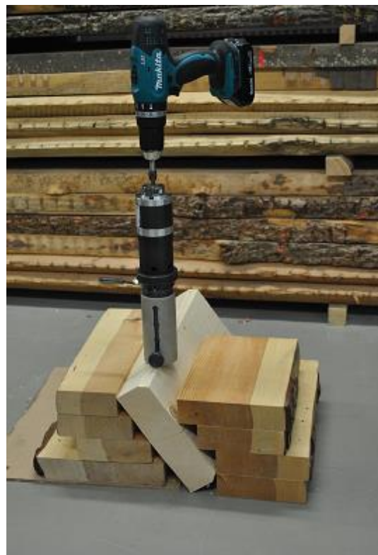
Obr. 12 Zkouška roztláčování ve vrtu prováděná v radiálním směru
