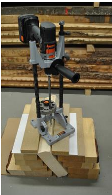
Obr. 11 Stojan s vrtačkou pro vyvrtání otvoru k měření roztláčovákem
