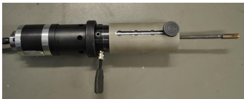
Obr. 7 Nově sestrojený přístroj k semidestruktivnímu testování dřeva
