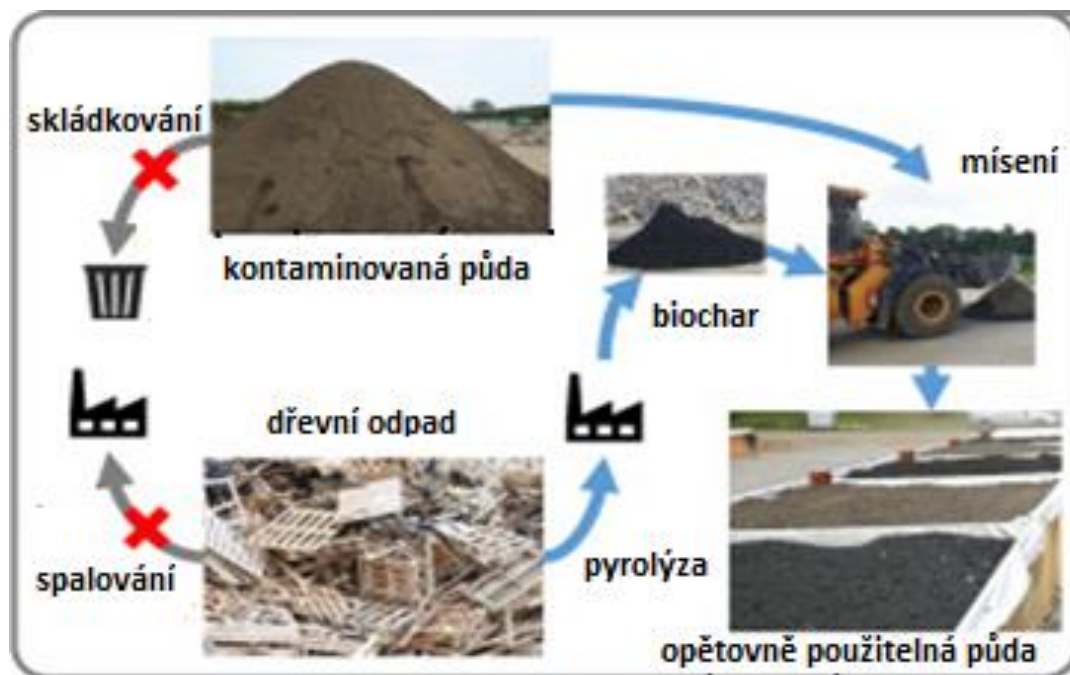
Obr. 16 Využití kontaminované půdy a biocharu k opětovnému použití půdy [51]
