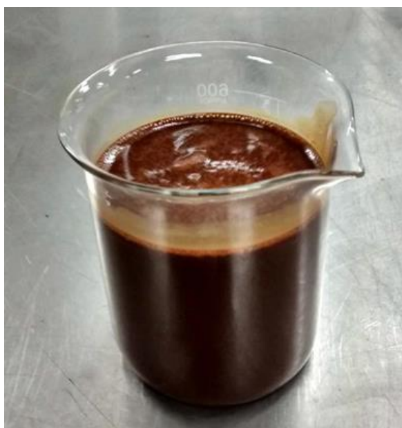
Obr. 6 Průmyslový odpadní lignin. [25]
