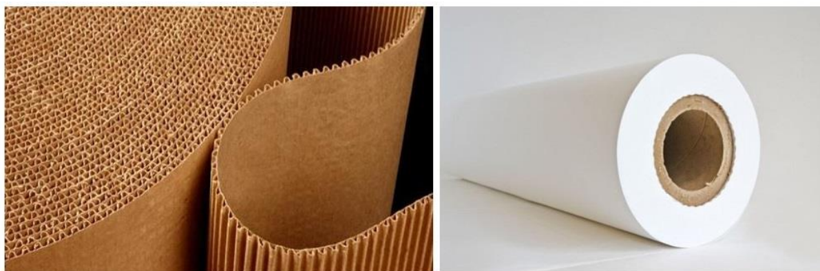
Obr. 5 Kraftliner používaný při výrobě obalového materiálu a bělený obalový papír vyrobený ze sulfátové buničiny. [6]
