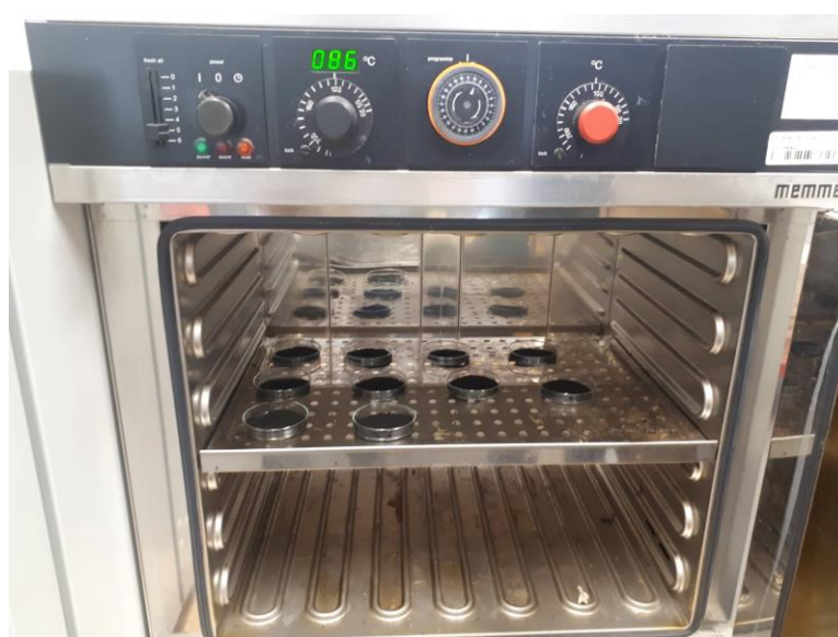
Obr. 19 Stanovení 0% vlhkosti vzorků biocharu v sušárně Memmert.
