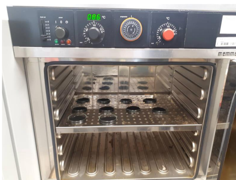
Obr. 19 Stanovení 0% vlhkosti vzorků biocharu v sušárně Memmert.
