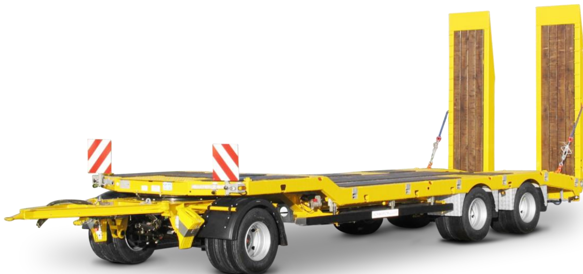
Obr. 7 Třínápravový nízkoložný přívěs se zalomeným rámem [8]
