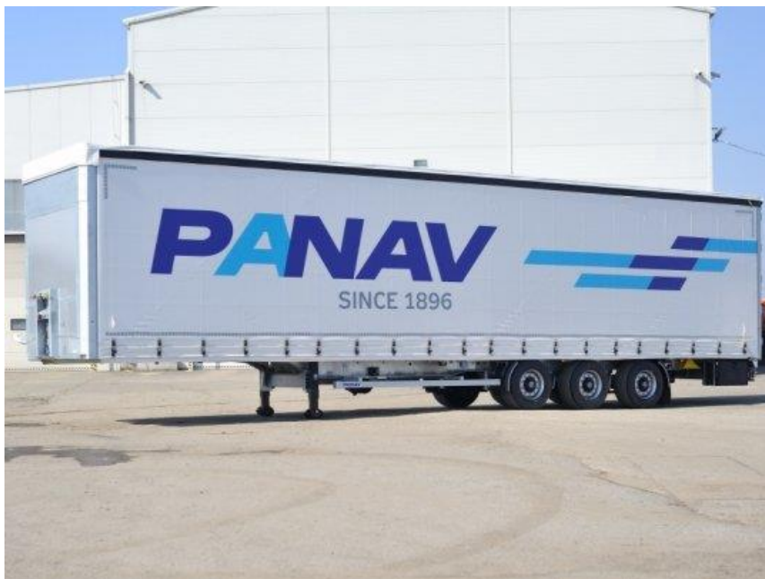
Obr. 6 Třínápravový valníkový plošinový návěs Panav [25]
