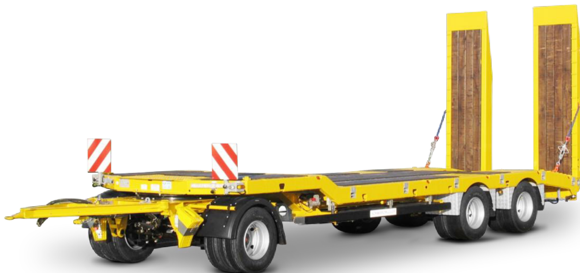
Obr. 7 Třinápravový nízkoložný přívěs se zalomeným rámem [8]
