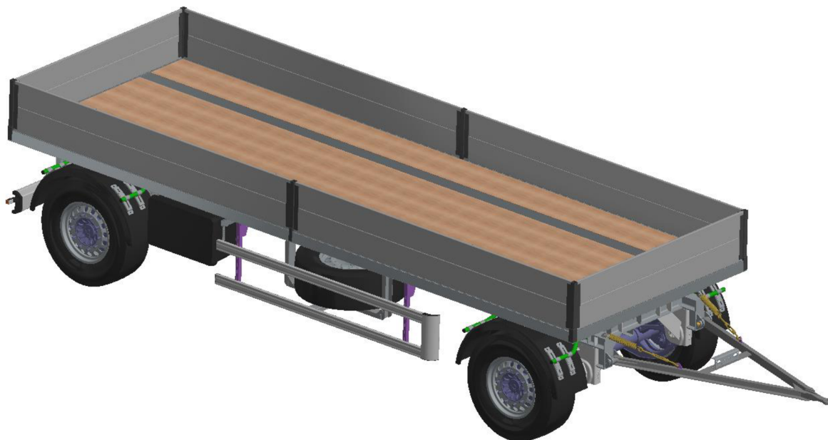
Obr. 12 Koncept dvounápravového valníkového točnicového přívěsu
