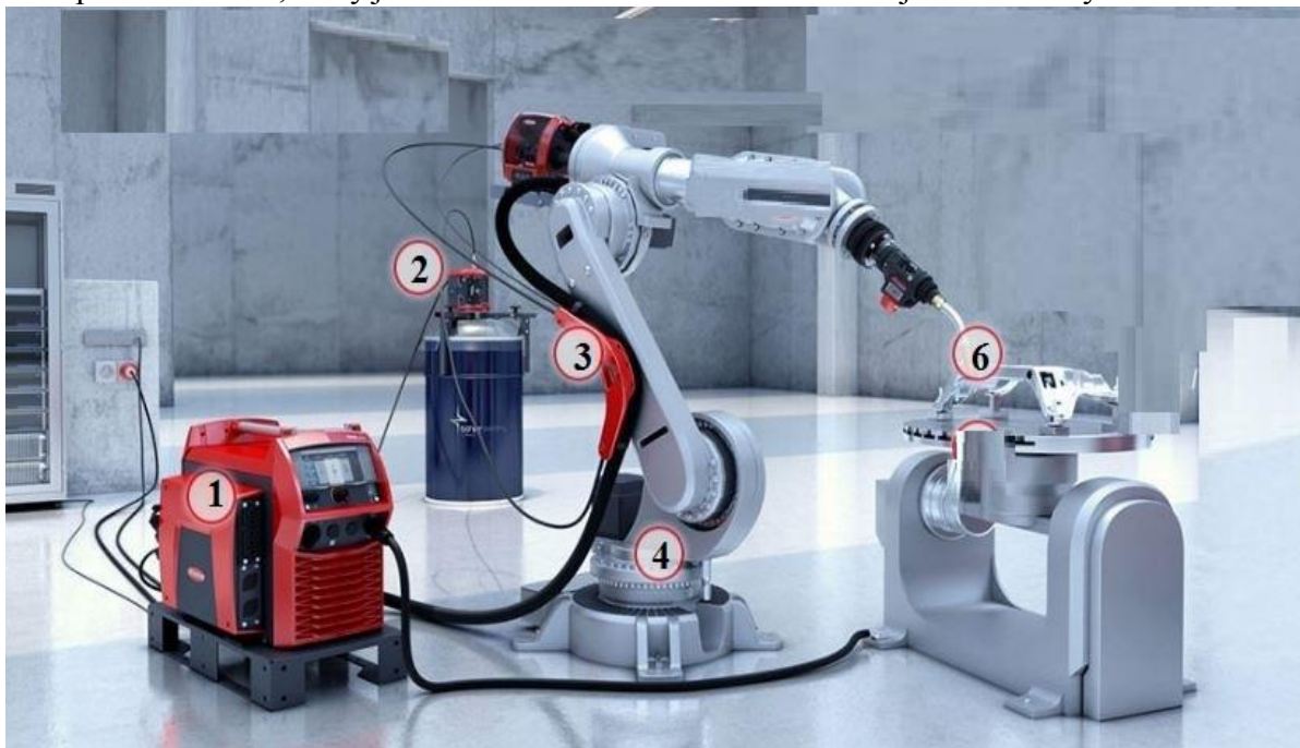
1 – zdroj svařovacího proudu, 2 – podavač drátů, 3 – pufrovací zásobník drátu, 4 – SpeedNet, 6 – svařovací hořák
