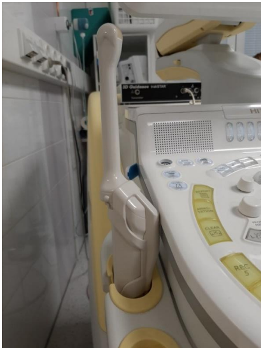
Obrázek 7 – Biopická sonda pro EUS naváděnou biopsii prostaty s názvem EUP-V53W (bez gumové rukavice).
