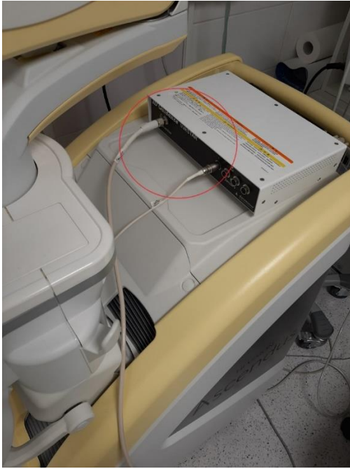
Obrázek 6 – Elektronická řídicí jednotka senzoru a vysílače magnetického pole napojená k HITACHI EUS přístroji.
