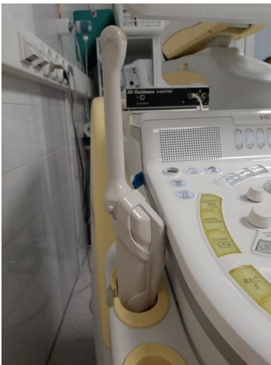
Obrázek 7 – Biopstická sonda pro EUS naváděnou biopsii prostaty s názvem EUP-V53W (bez gumové rukavice).
