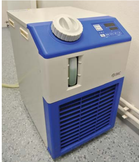
Obr. 6 Chladič ložisek osy vřetene.
