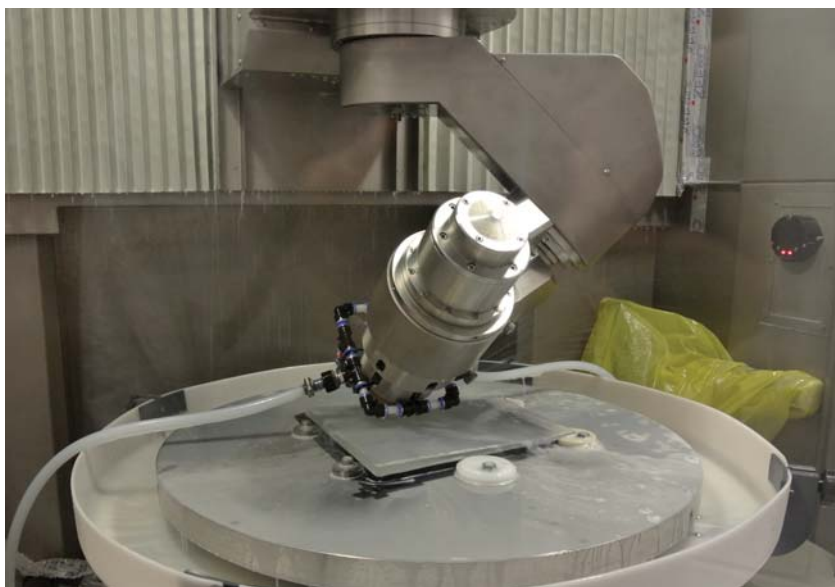
Obr. 33 Asférické zrcadlo upevněné vakuem a utěsněné elektrickářskou páskou v momentě rastrování asférického povrchu hrncovou frézou.
