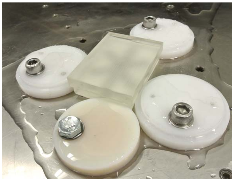
Obr. 32 Příklad upevnění vzorku pomocí excentrických držáků.
