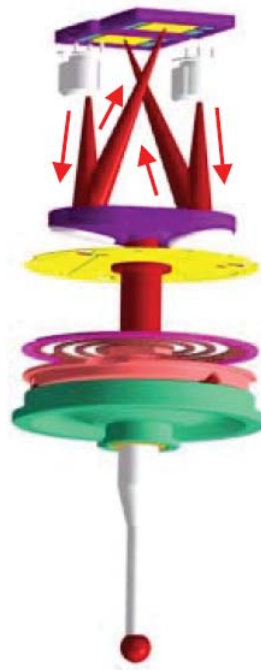
Obr. 23 Schématické znázornění sondy Renishaw SMP-25 s červenými šipkami vyznačenou trajektorií infračerveného paprsku dopadajícího na poziční senzory
