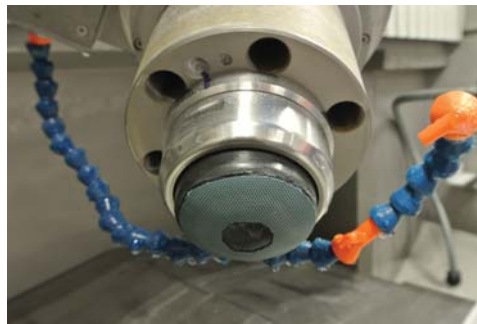
Obr. 12 Bonnet s přilepeným diamantovým plátnem upevněný v nástrojové hlavě CNC centra Zeeko IRP-800G.
