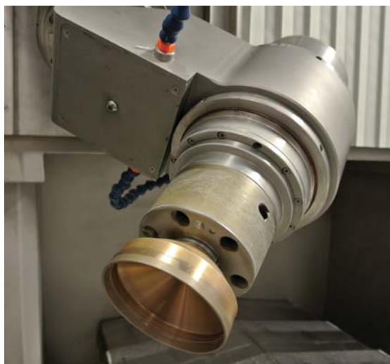
Obr. 8 Frézovací nástroj s vázaným diamantovým zrnem.
