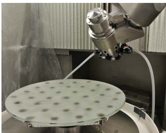
Obr. 27 Skleněný výlisek přilepený na duralovém držáku umístěný uvnitř obráběcího centra IRP800G.
