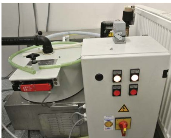
Obr. 5 Jednotka pro zajištění recirkulace a čištění abrazivní kapaliny.
