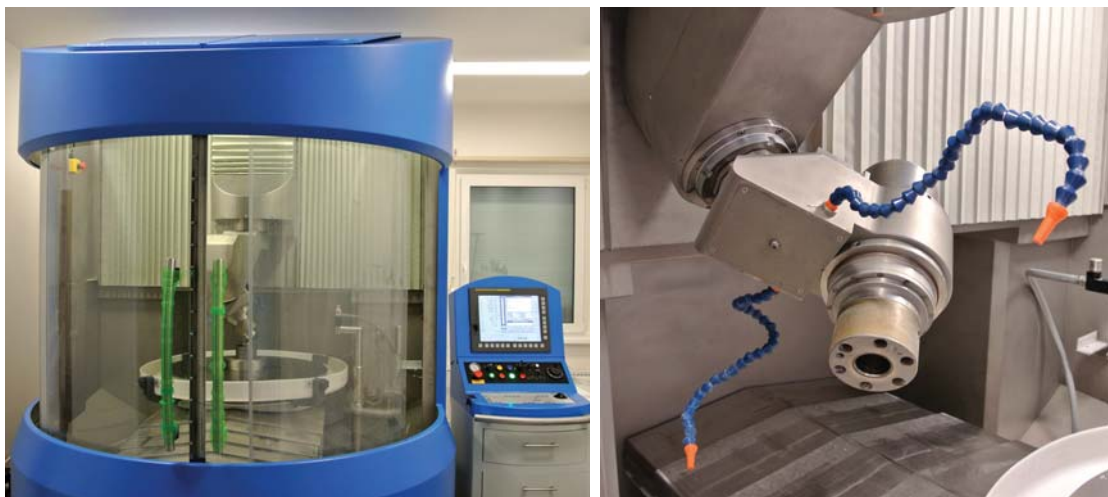
Obr. 2 Reálný snímek CNC obráběcího centra Zeeko IRP-800G a detail jeho nástrojové hlavy.
