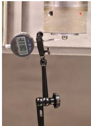
Obr. 7 Kalibrační kulička a digitální úchylkoměr.
