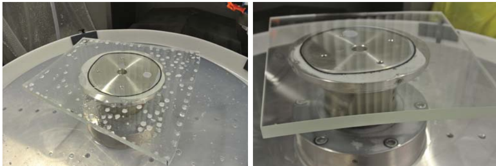
Obr. 36 Finální tvar lichoběžníku (vlevo) a detail fazety.
