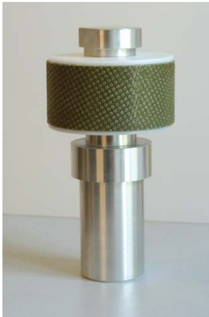
Obr. 28 Speciální nástroj pro obvodové konturování – gumový buben s nasunutým abrazivním plátnem, na jehož povrchu jsou diamantové pelety (KGS Flexis® zrnitost 60).
