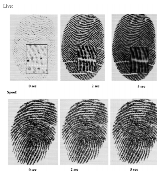
Obrázek 4.3: Srovnání vývoje detekce potu v čase mezi živým a falešným prstem [27]
