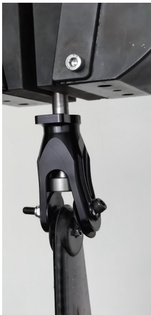
Obrázek 27: Lom šroubu a deformace unašeče
