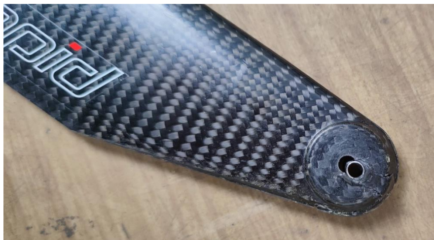
Obrázek 26: Poškozený kořen listu
