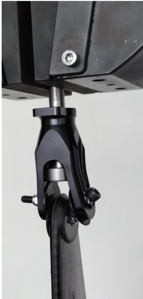
Obrázek 27: Lom šroubu a deformace unašeče
