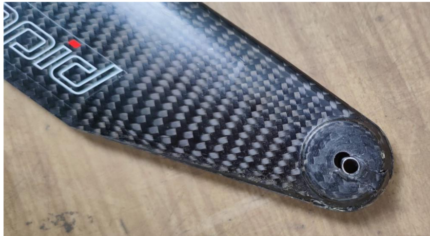
Obrázek 26: Poškozený kořen listu
